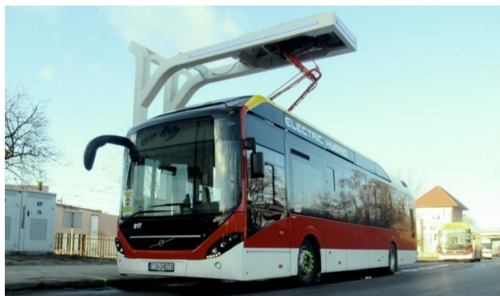
Rys. 20 Ładowarka pantografowa OppCharge w Inowrocławiu
