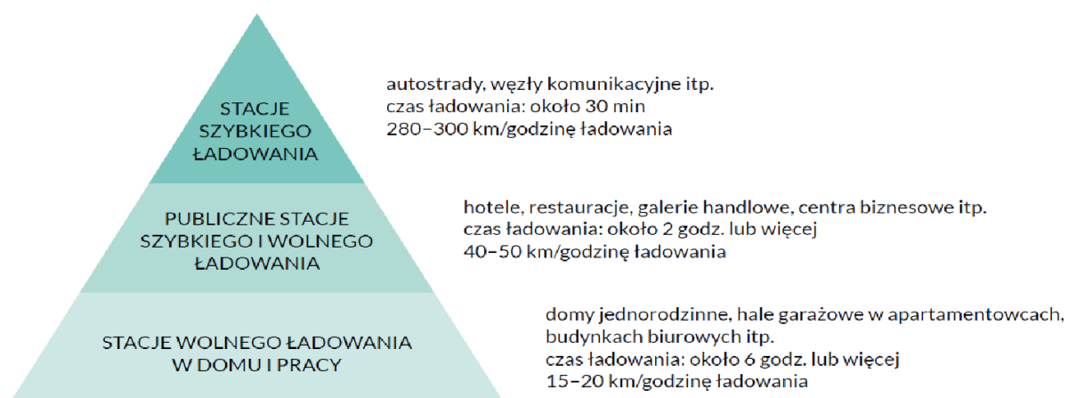
Rys. 27 Rekomendowany miks infrastruktury ładowania pojazdów EV
