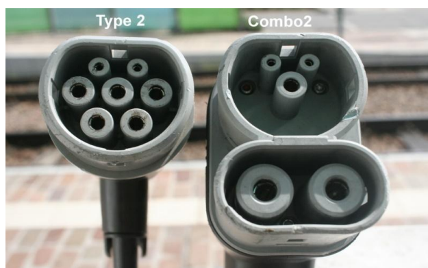
Rys. 17 Wtyczka Type 2 (po lewej) obok wtyczki (po prawej) Type 2 CCS / Type 2 combo / Combo 2
