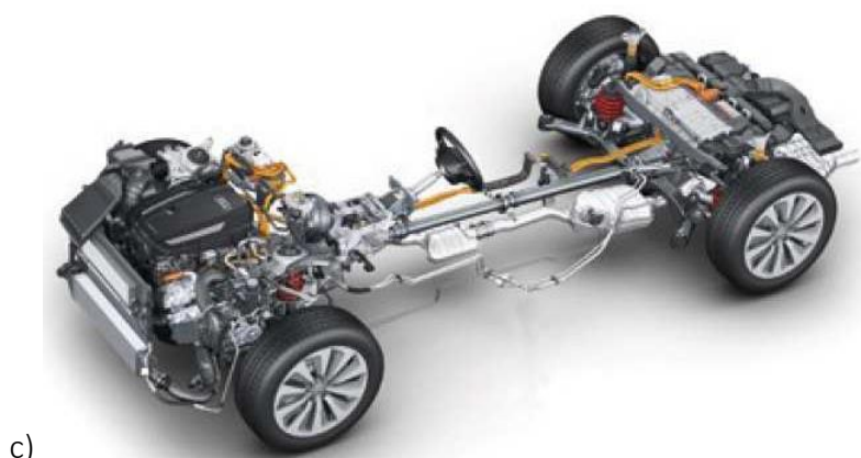
Rys. 10 Schemat blokowy hybrydowego pojazdu elektrycznego – HEV: a) hybryda szeregową, b) hybryda równoległa, przykład rozwiązania konstrukcyjnego
